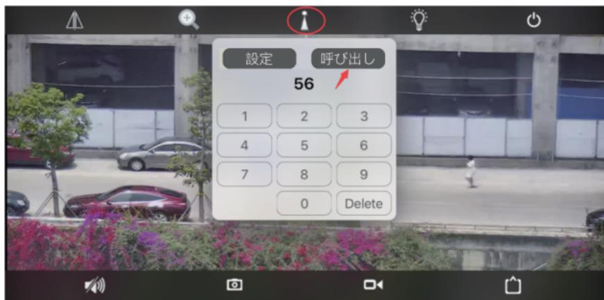
全てのプリセットを削除する方法は、'115'を入力して、'呼び出し'をクリックしてください。
