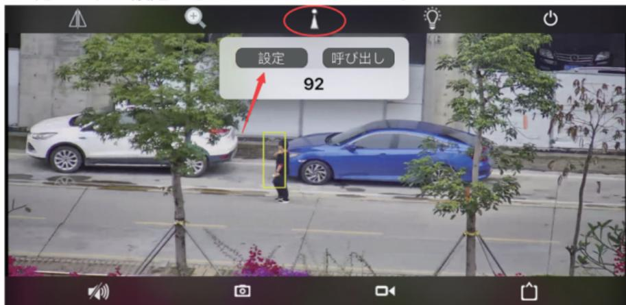
自動追跡機能をオンにする方法：'92'を入力して、'呼び出し'をクリックしてください。監視範囲に人が通り過ぎたとき、カメラが自動的に追跡します。人がカメラ画面から消えたら、カメラの向きは追跡開始前の位置に戻ります。
